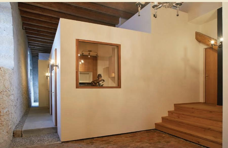
Fig. 2. Manège du château de Method, vue du rez-de-chaussée avec ses espaces privés, chauffés, sous forme de «boîtes dans la boîte» (photo ZAK Andrea Zaccone).
